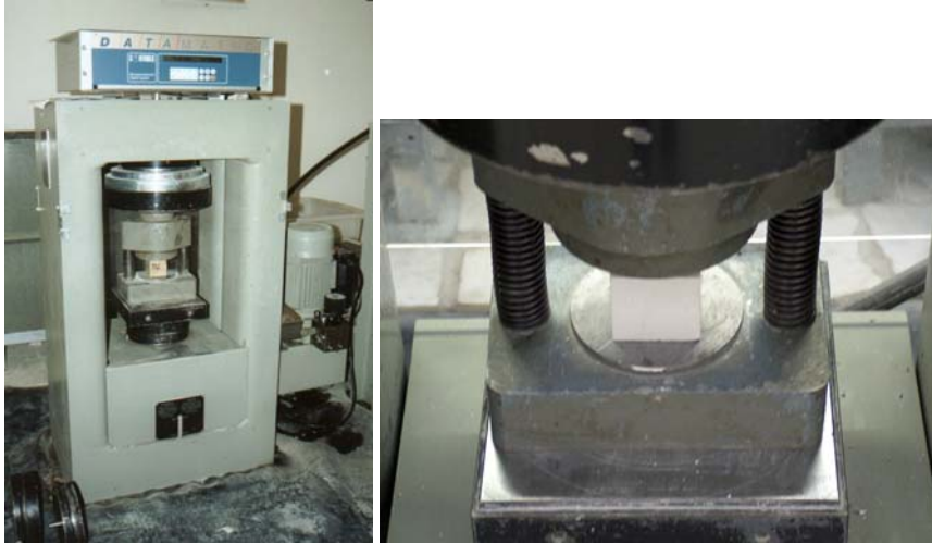
Slike 9.-10. Ispitivanje tlačne čvrstoće, sa detaljom ispitivanja (desno)
