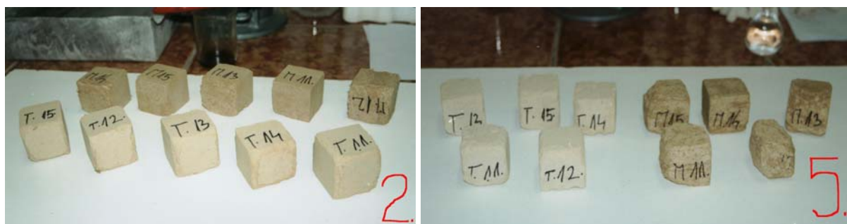
Slike 11.-12. Kamene kocke tenelije i miljevine prije (gore) i poslije (dolje) ispitivanja otpornosti na mraz natrijevim sulfatom
