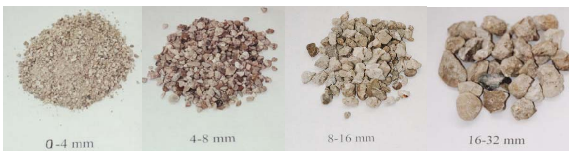
Slika 12. Reciklirani agregat – “stari” beton nakon prerade
