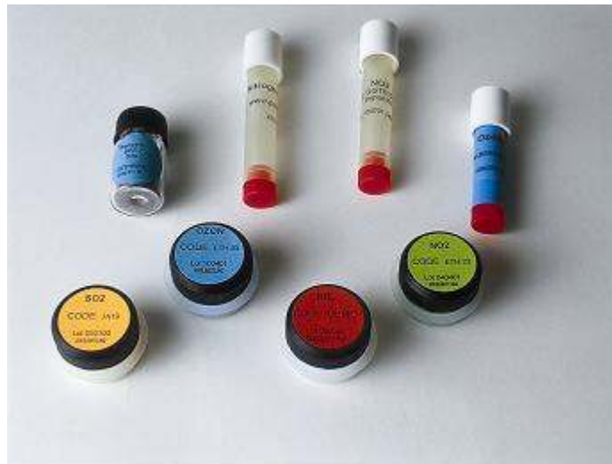
Slika 2: Pasivni mjeraci – različite izvedbe za različite namjene
