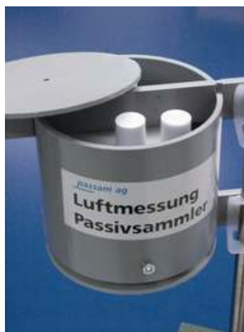
Slika 3. Zaštitna kućišta u koja se montiraju mjerne cjevčice ili membrane
