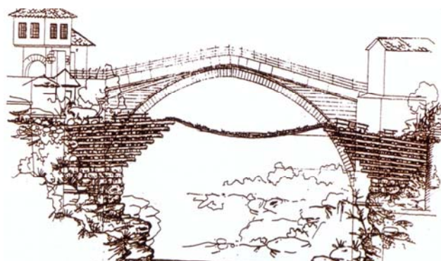
Slika 3. Skica prof. Gojkovića – rekonstrukcija drvenog visećeg mosta, u odnosu na Stari most[1]
