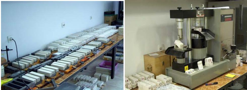
Slike 10.-11. Priprema i njegovanje uzoraka morta za ispitivanje tlačne čvrstoće (lijevo); Ispitivanje savojnih i tlačnih čvrstoća mortova na preši (desno)
