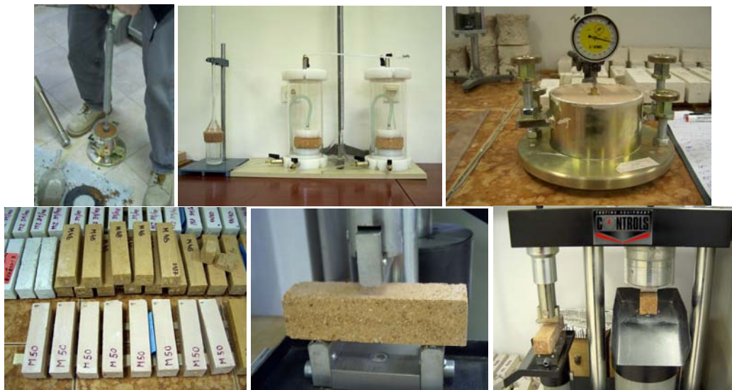
Slike 5.-10. Detalji ispitivanja svojstava Dark Red morta
