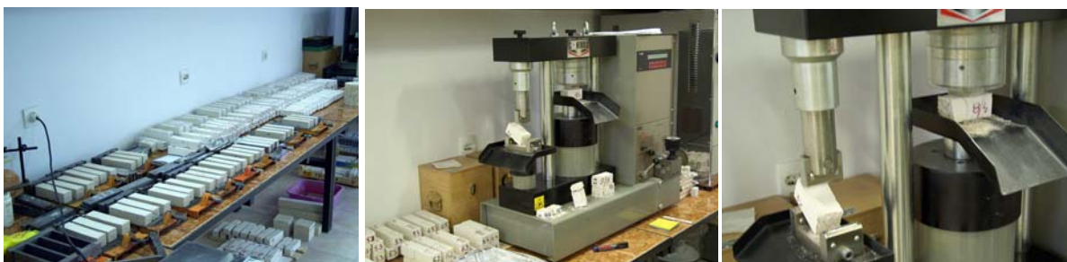
Slike 36.-38. Priprema i njegovanje uzoraka morta za ispitivanje tlačne čvrstoće (lijevo); Ispitivanje savojnih i tlačnih čvrstoća mortova na preši (u sredini), sa detaljom (desno)
