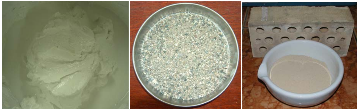
Slike 4.-6. Komponente mortova za zidanje luka i zidova ispune: vapneno tijesto, pijesak i lomljena opeka
