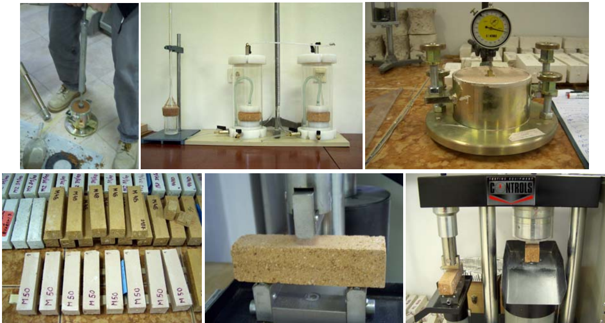
Slike 21.-26. Detalji ispitivanja svojstava Dark Red morta
