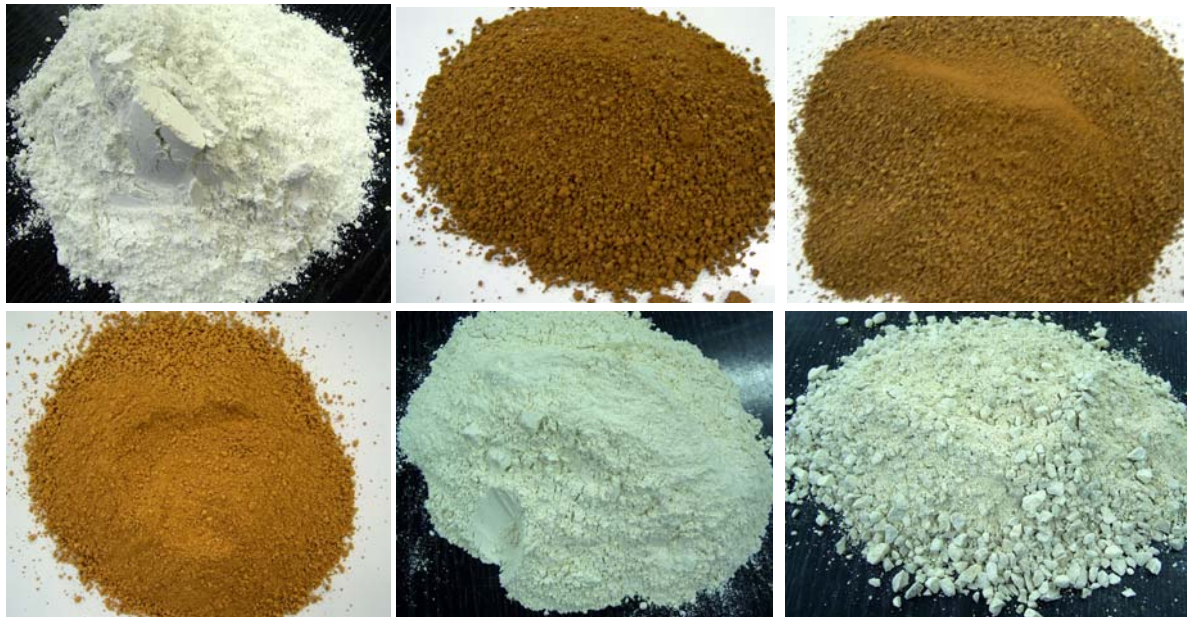
Slike 7.-12. Komponente mortova za zidanje mortova ispod kaldrme: hidratizirano vapno, crvenica, boksit, lomljena opeka, kameno brašno i drobljeni pijesak
