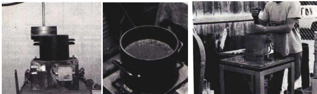
Slike 10.-12. Vebe-aparat sa dodatnim teretom od 22,7 kg; Zbijeni uzorak UB u Vebe-loncu; Određivanje konzistencije na Vebe-stolu
