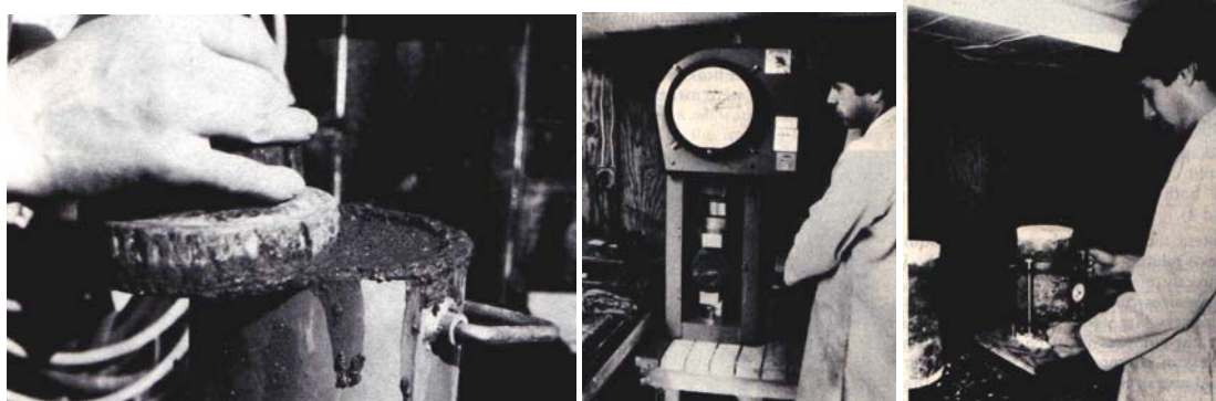
Slika 17. Priprema ispitnih uzoraka od UB Slike 18.-19. Ispitivanje čvrstoće uzoraka UB
