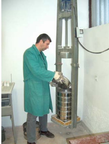
Slike 3.-4. Granulometrijska analiza agregata (lijevo), detaljom sita (desno)
