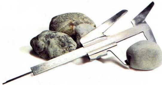
Slika 5. Ispitivanje oblika zrna agregata
