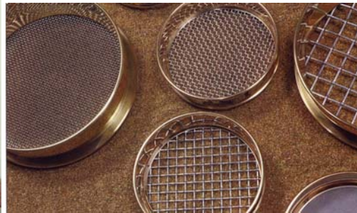
Slike 3.-4. Granulometrijska analiza agregata (lijevo), detaljom sita (desno)
