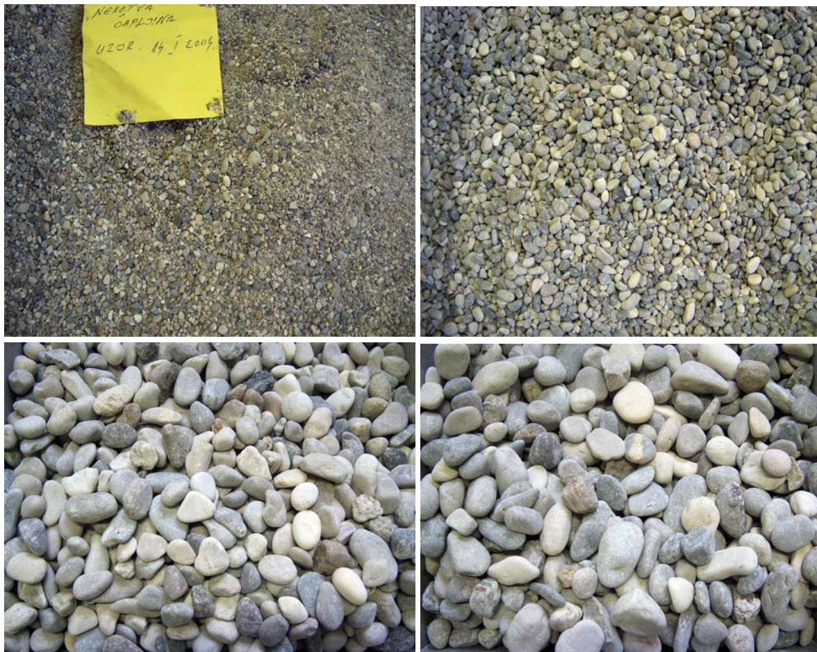
Slike 6.-9. Frakcije riječnog agregata («Konstruktor-Neretva» Čapljina)
